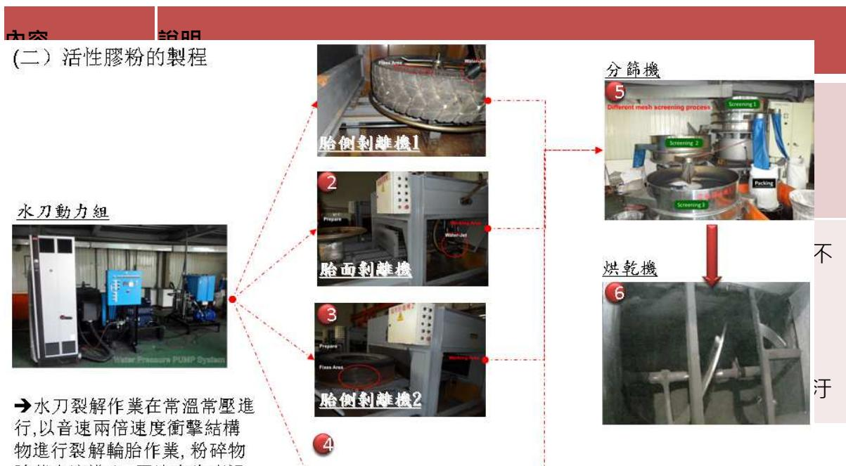
→水刀裂解作業在常溫常壓進行，以音速兩倍速度衝擊結構物進行裂解輪胎作業，粉碎物隨著水流導出，因次在生產過程中沒有粉塵汙染工作環境相對乾淨，複合環保生產標準
